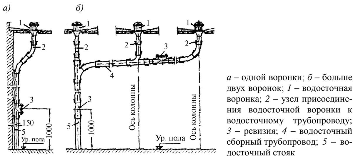
Рисунок 10.1 – Присоединение к водосточному стояку водосточных воронок
