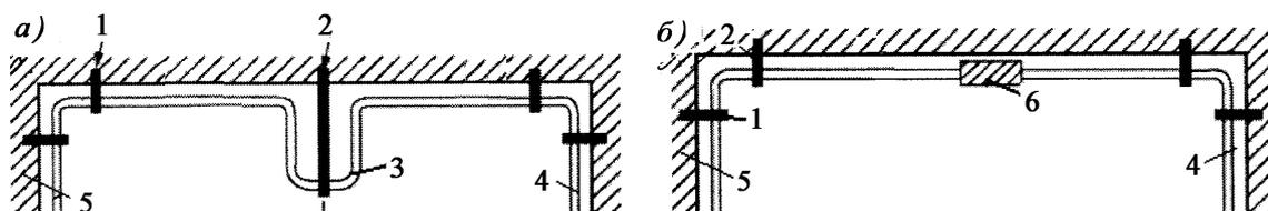
а – с П-образным компенсатором; б – с сильфонным компенсатором; 1 – неподвижная опора; 2 – подвижная опора; 3 – П-образный компенсатор; 4 – трубопровод; 5 – стена; б – сильфонный компенсатор
