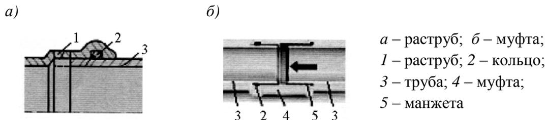
Рисунок 6.18 – Соединения канализационных труб из наполненного полипропилена
