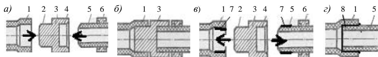
*а* – введение нагревателя; *б* – оплавление концов труб; *в* – выведение оплавленных труб из нагревателя; *г* – соединение труб; 1 – раструб; 2 – дорн; 3 – нагревательный элемент; 4 – гильза; 5 – гладкий конец; 6 – хомут; 7 – оплавленные поверхности; 8 – сварной шов (стрелками показано направление перемещения свариваемых трубных деталей)
