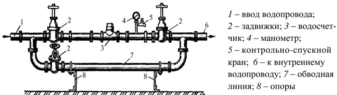
Рисунок 8.16 – Водомерный узел (стрелками показано направление течения воды)
