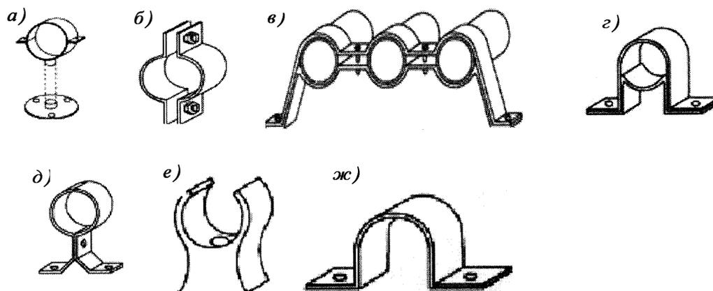
*a* – опора с удлинителем и опорной пластиной; *б* – подвесная опора; *в* – тройная опора; *г* – изолирующая опора; *д* – скользящая опора; *е* – пластиковый зажим; *ж* – прижимная опора
