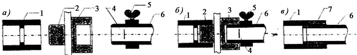
*а* – подготовка к сварке; *б* – оплавление свариваемых поверхностей; *в* – сопряжение трубы и муфты; 1 – муфта; 2 – дорн нагревательного устройства; 3 – гильза нагревательного устройства; 4 – метка на внешней поверхности конца трубы; 5 – ограничительный хомут; 6 – труба; 7 – сварной шов
