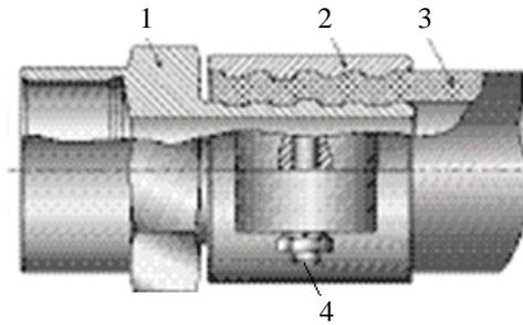
1 – штуцер с монтажным шестигранником и резьбовым хвостовиком; 2 – обжимной хомут; 3 – труба из ПЭ-С; 4 – стяжной болт с гайкой
