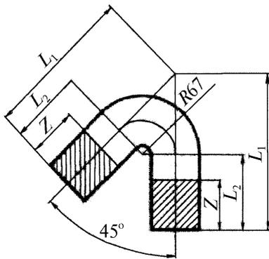
Рисунок 6.9 – Канализационный безраструбный обводной отвод из ковкого чугуна (масса 5 кг для диаметра 100 мм)
