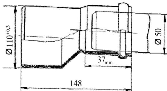
Рисунок 6.11 – Канализационный эксцентрический переход 110×50 мм из НПВХ
