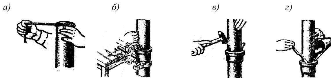
*a* – намотка жгута; *б* – конопатка жгута; *в* – центровка трубы; *г* – заливка цементного раствора
