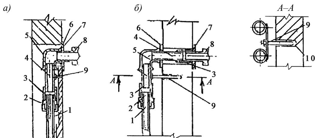
1 – подводка из МПТ; 2 – соединительная деталь; 3 – муфта стандартная; 4 – патрубок из стальной трубы; 5 – угольник стандартный; 6 – шайба упорная; 7 – шайба декоративная; 8 – арматура водоразборная; 9 – крепление; 10 – дюбель
