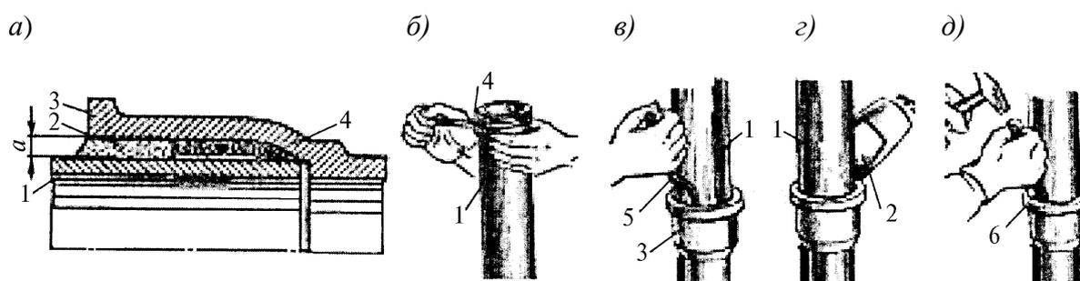
*a* – соединение в разрезе; *б* – подмотка смоляного каната; *в* – конопатка каната; *г* – заливка цементного раствора; *д* – чеканка цементного раствора; *1* – гладкий конец трубы; *2* – цемент; *3* – раструб; *4* – смоляная прядь; *5* – конопатка; *б* – чеканка
