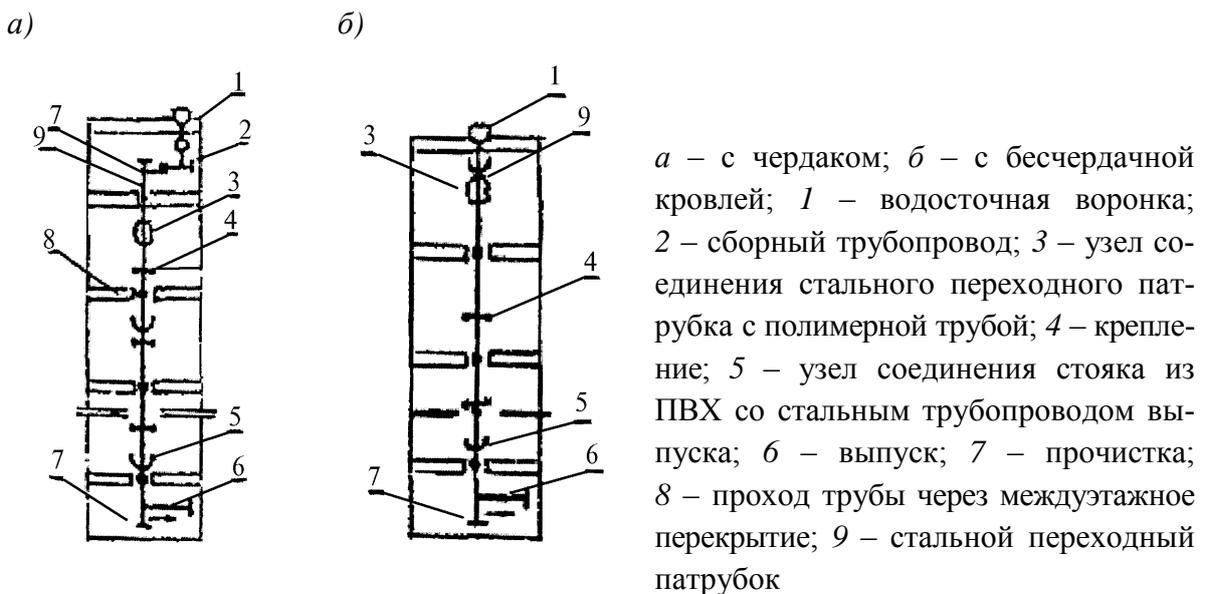
Рисунок 10.7 – Монтажные схемы водосточных стояков в зданиях
