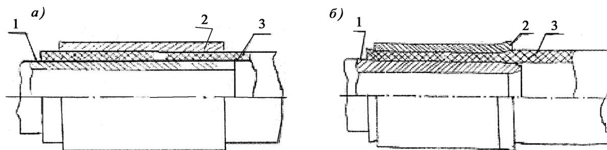
а – до обжимки; б – после обжимки; 1 – штуцер; 2 – обойма; 3 – труба
