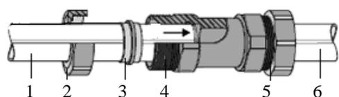
1, 6 – трубы из ХПВХ; 2 – накидная гайка;
