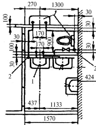
а – обработанный эскиз (условно разделен на блоки I – VI); б – эскиз с натурными размерами строительных длин; в – план; 1 – приборы; 2 – водопроводные стояки; 3 – водопроводные подводки
