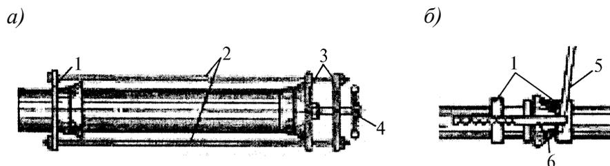
*а* – винтовым приспособлением; *б* – рычажно-реечным приспособлением; 1 – захват; 2 – тяги; 3 – упоры; 4 – винт; 5 – рычаг; 6 – рейка
