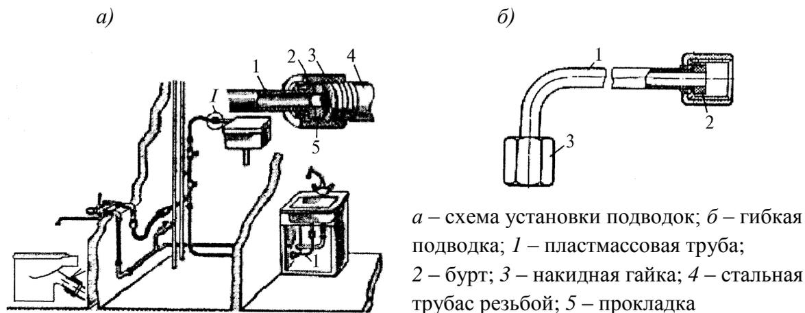
Рисунок 8.15 – Гибкие подводки и крепление арматуры
