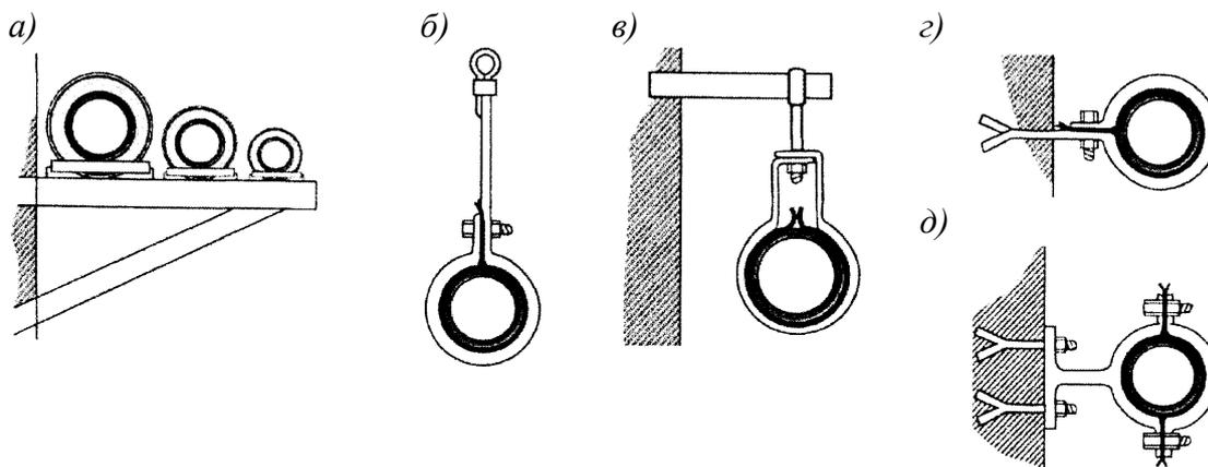
*a* – крепление на кронштейне; *б* – подвеска к потолку; *в* – подвеска к стене; *г* – крепление на одинарном хомуте к стене; *д* – на парных хомутах к стене
