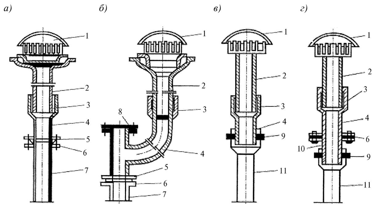
1 – водосточная воронка; 2 – сливной патрубок воронки; 3 – заделка канатом и цементом; 4 – стальная переходная деталь; 5 – резиновая прокладка; 6 – фланцевое соединение; 7 – отбортованный патрубок; 8 – прочистка; 9 – соединение на резиновом кольце стальной и пластмассовой труб; 10 – чугунный патрубок «фланец – гладкий конец»; 11 – полимерный патрубок с раструбом
