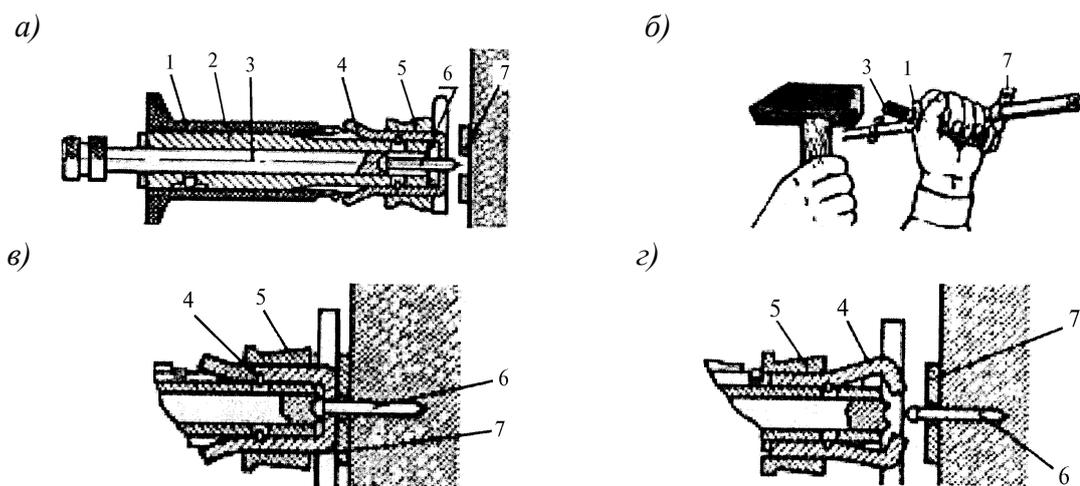
а – установка оправки с дюбелем ; б – забивка дюбеля; в – забитый дюбель; г – освобождение головки дюбеля; 1 – эластичная ручка; 2 – корпус; 3 – сменный боек; 4 – губки; 5 – зажимное кольцо; 6 – дюбель; 7 – закрепляемая деталь (скоба)
