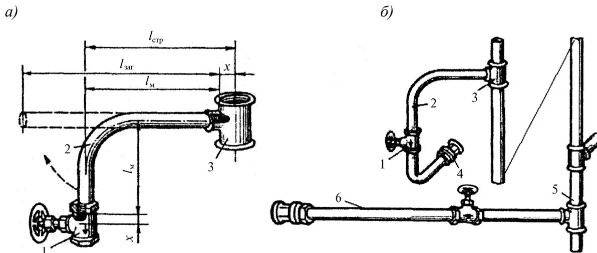
1 – вентиль; 2 – отвод; 3 – прямой неравнопроходный тройник; 4 – муфта и контргайка на длинной резьбе; 5 – бочонок; 6 – сгон
