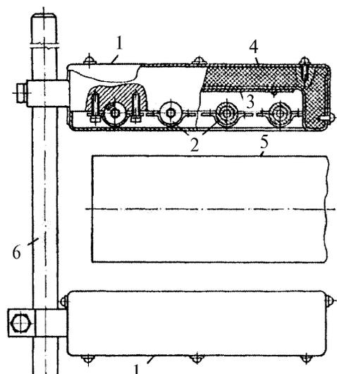
1 – нагреватели; 2 – инфракрасные излучатели; 3 – отражающий короб; 4 – тепловая изоляция; 5 – полимерная труба; 6 – стойка
