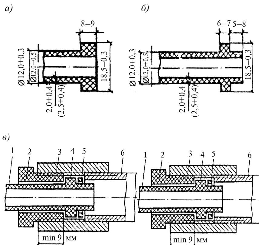
*a* – с формованным утолщенным буртом под накидную гайку; *б, в* – с наплавляемым (литым) утолщенным буртом; *б* – под накидную гайку, *в* – под футорку; *1* – подводка из ПВД; *2* – футорка; *3* – муфта чугунная  $D_y = 15$  мм; *4* – наплавленный бурт; *5* – резиновая прокладка; *б* – стальная труба  $D_y = 15$  мм
