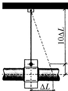
Рисунок 8.12 – Крепление водопровода из медных труб хомутом на подвеске, учитывающей температурные перемещения
