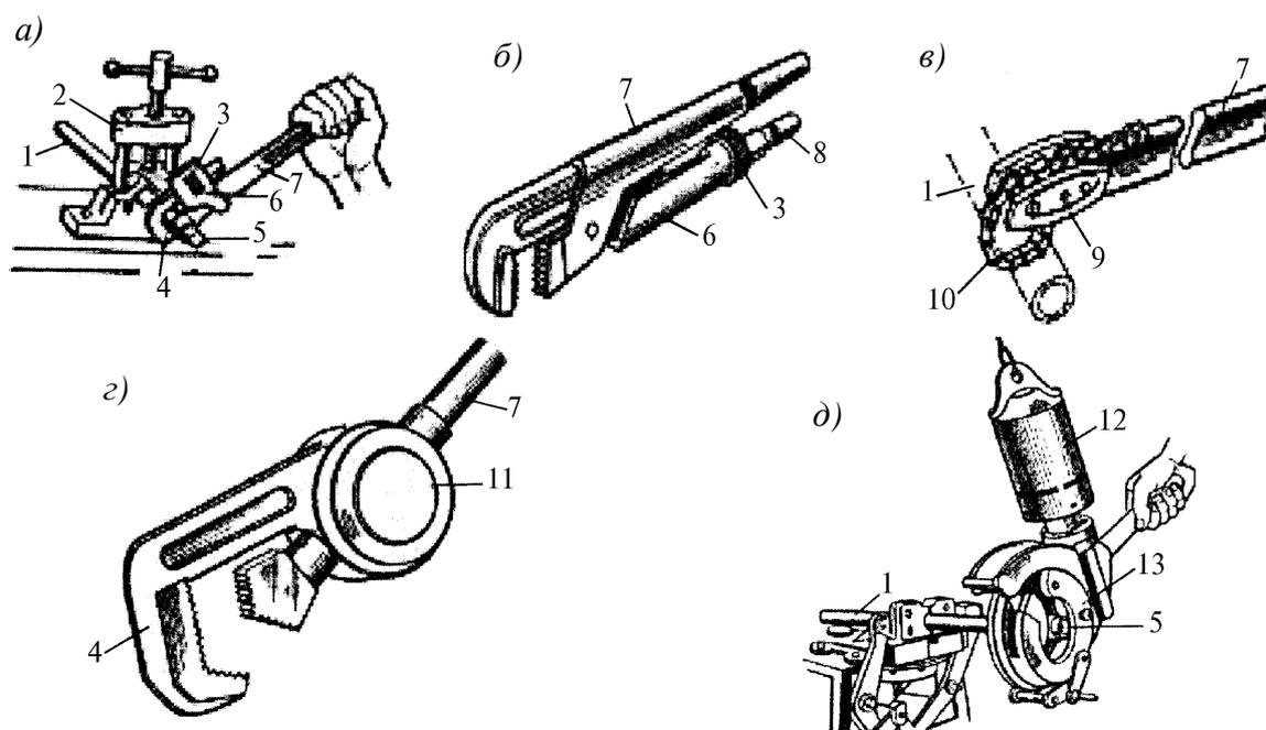
*a* – раздвижной; *б* – рычажный; *в* – цепной; *г* – накидной; *д* – приводной;
