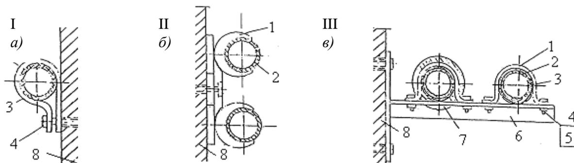
I – одиночного водопровода; II, III – парных водопроводов; *a*, *б* – вертикального размещения; *в* – горизонтального размещения; 1 – хомут; 2 – трубопровод; 3 – прокладка; 4 – крепежный болт; 5 – шайба; 6 – уголок-консоль; 7 – теплоизоляция; 8 – строительная конструкция (см. СП 40-103-98 [7])
