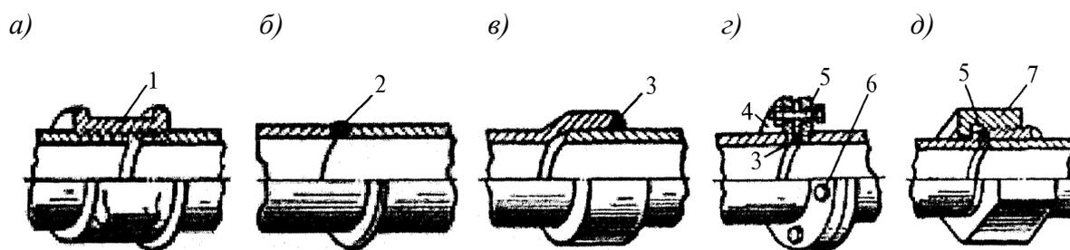
*a* – резьбовое; *б* – сварное стыковое; *в* – сварное внахлест; *г* – фланцевое; *д* – с накидной гайкой; 1 – муфта; 2 – сварной шов; 3 – раструб; 4 – фланец; 5 – уплотнительная прокладка; 6 – болт с гайкой; 7 – накидная гайка
