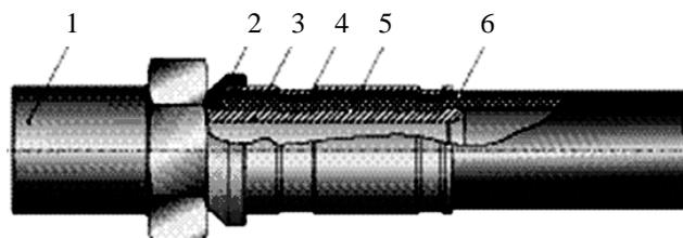
1 – муфта металлической соединительной детали с внутренней резьбой; 2 – торцевая пластмассовая прокладка со смотровым окошком для контроля правильности сборки соединения (в некоторых конструкциях соединений смотровое окошко выполняется непосредственно на обжимной муфте 4); 3 – штуцер – опорная втулка; 4 – стальная обжимная муфта; 5 – эластичные уплотнительные кольца; 6 – металлополимерная труба
