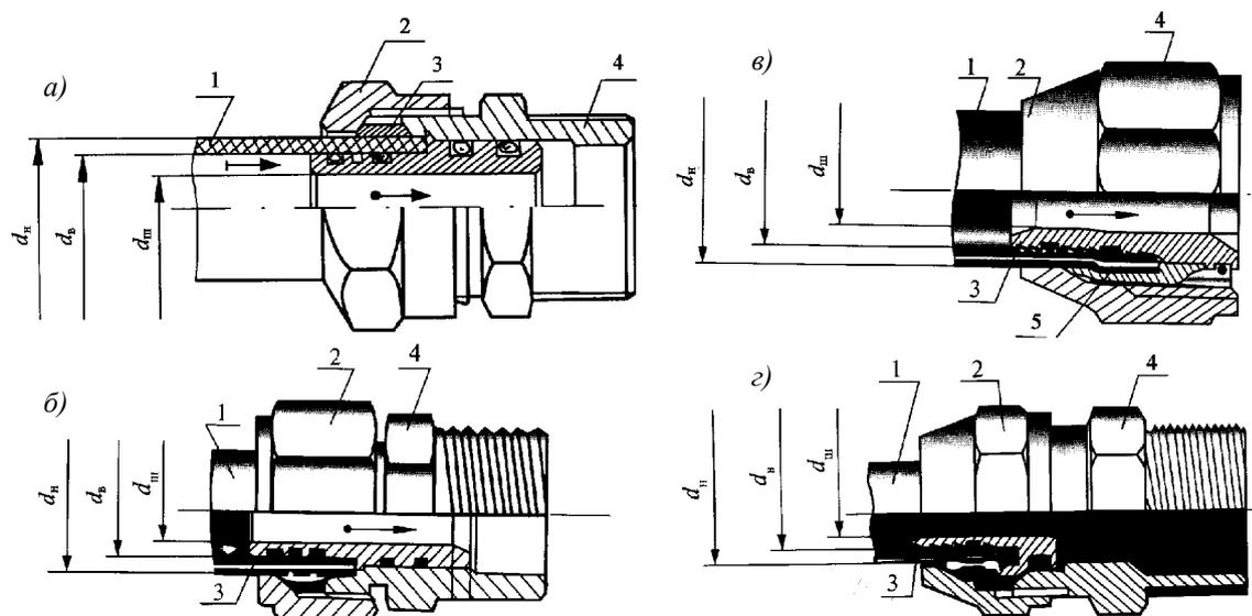
а – схема соединения металлополимерных труб; б – схема соединения с разрезным кольцом; в – соединение с неразрезным уплотнительным кольцом; г – схема соединения типа «евроконус»; 1 – пластмассовая или металлопластмассовая труба; 2 – накидная гайка; 3 – штуцер; 4 – переходной элемент; 5 – неразрезное кольцо;  $d_{ш}$  – внутренний диаметр штуцера;  $d_n, d_b$  – наружный и внутренний диаметры трубы;  $\rightarrow$  – направление движения воды (жидкости)
