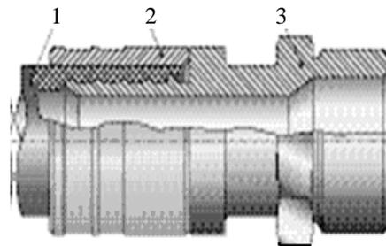
1 – труба из ПЭ-С; 2 – подвижная латунная муфта; 3 – штуцер с гайкой и хвостовиком с внутренней резьбой
