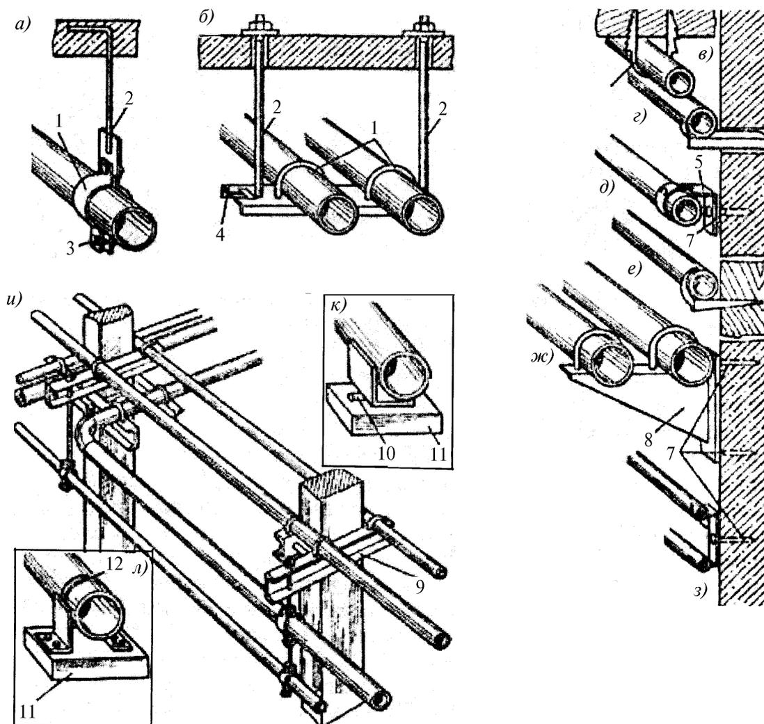
*a* – на подвеске; *б* – на подвеске с опорной балкой; *в* – скобой; *г* – на кронштейне; *д* – хомутом; *е* – крючком; *ж* – на кронштейне с подкосом; *з* – приварной скобой; *и* – на колоннах; *к* – на подвижной опоре; *л* – на неподвижной опоре; 1, б – хомуты, 2 – тяга; 5 – болт; 4 – балка; 5 – скоба; 7 – дюбель; 8 – подкос; 9 – швеллер; 10 – каток; 11 – основание; 12 – сварка с использованием различного вида креплений
