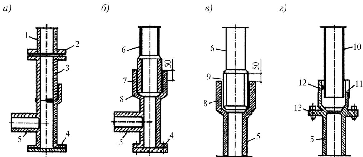
1 – пластмассовая труба с отбортовкой; 2 – фланцевое соединение; 3 – стальной патрубок с фланцем; 4 – прочистка; 5 – стальной трубопровод выпуска; 6,10 – пластмассовая труба; 7 – запрессованный стальной патрубок; 8 – заделка канатом и цементом; 9 – вклеенный патрубок из НПВХ; 11 – чугунная деталь «фланец – раструб»; 12 – резиновое кольцо; 13 – фланцевое соединение
