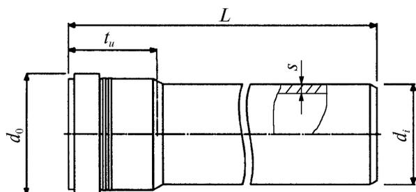
Рисунок 6.14 – Толстостенная канализационная труба из ПВХ
