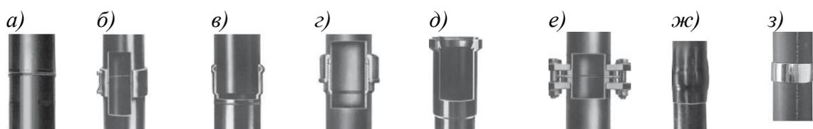
Рисунок 6.15 – Соединение канализационных трубных изделий из наполненного полиэтилена
