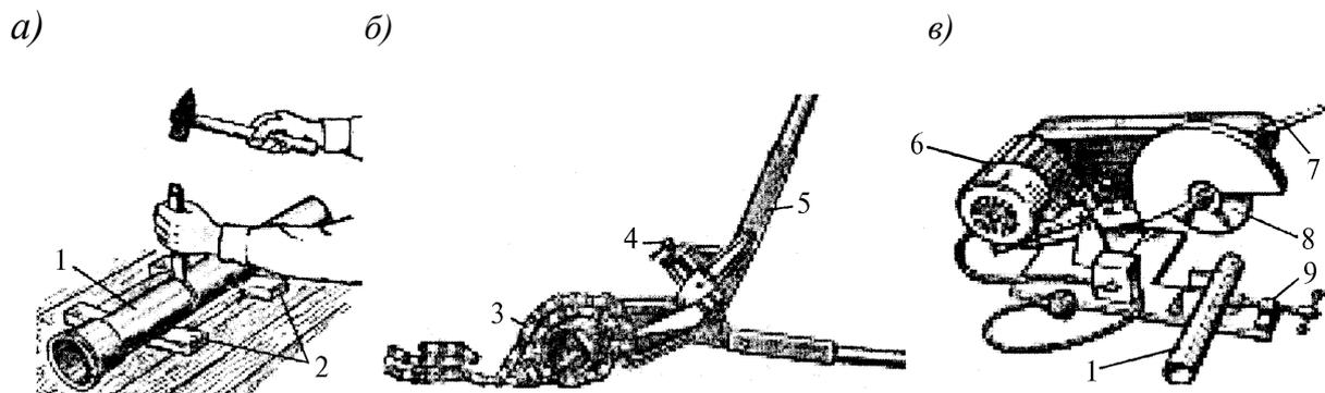
*а* – зубилом; *б* – труборезом ручным; *в* – маятниковой пилой; *1* – труба; *2* – подкладки; *3* – режущая цепь; *4* – натяжное устройство; *5*, *7* – рукоятки; *6* – электродвигатель; *8* – режущий диск; *9* – прижим
