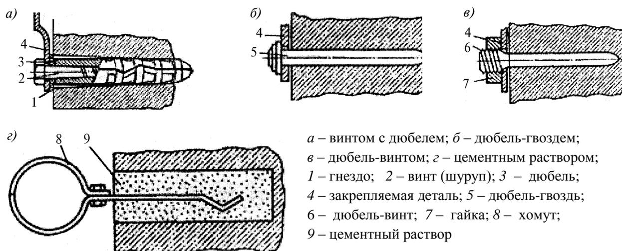
Рисунок 8.5 – Установка крепежа водопроводов в строительных конструкциях
