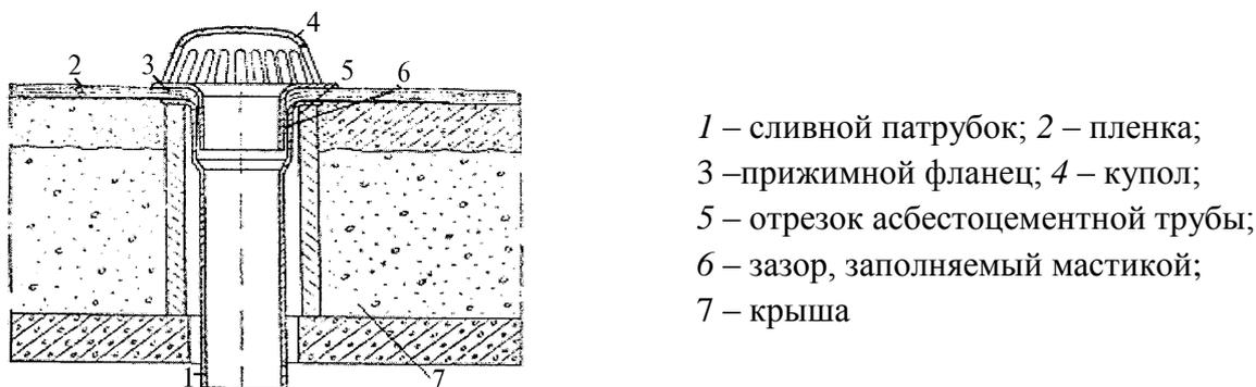
Рисунок 10.6 – Пластмассовая водосточная воронка на крыше
