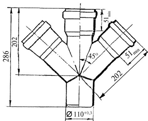
Рисунок 6.12 – Канализационная равнопроходная косая 45° крестовина из НПВХ
