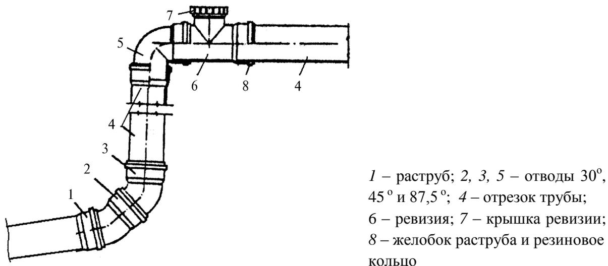
Рисунок 7.10 – Трубозаготовка, выполненная из труб и соединительных частей из НПВХ с раструбными соединениями на резиновых кольцах
