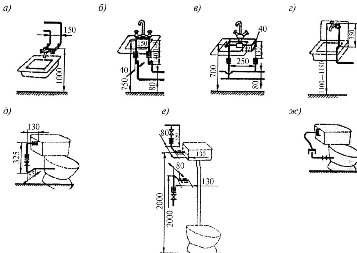
*а* – к настенному смесителю для умывальника; *б* – к смесителю с нижней камерой смешения; *в* – к центральному смесителю умывальника; *г* – к водоразборному крану; *д* – к поплавковому клапану бачка; *е* – к поплавковому клапану высокорасполагаемого смывного бачка при подводке сверху и снизу; *ж* – подсоединение гибкой подводкой
