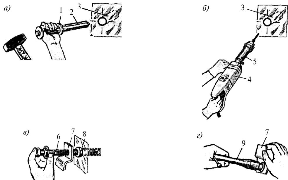
*а* – пробивка отверстия пробойником; *б* – то же, электрической сверлилкой; *в* – сборка крепления; *г* – затяжка крепления; *1* – оправка; *2* – пробойник; *3* – отверстие; *4* – электрическая сверлильная машина; *5* – ударно-вращательная насадка; *6* – винт (шуруп); *7* – закрепляемая деталь (скоба); *8* – дюбель; *9* – ключ
