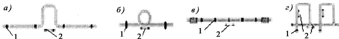
Компенсаторы: а – П-образный; б – круговой; в – сильфонный; г – угловой; 1 – подвижное крепление; 2 – направления перемещения
