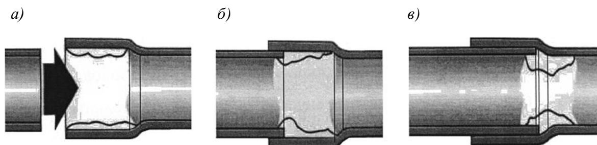
*a* – нанесение флюса на внутреннюю поверхность раструба перед пайкой; *б* – продвижение флюса по раструбу; *в* – переход раструба в трубопровод
