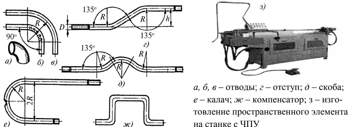
*а, б, в* – отводы; *г* – отступ; *д* – скоба; *е* – калач; *ж* – компенсатор; *з* – изготовление пространственного элемента на станке с ЧПУ
