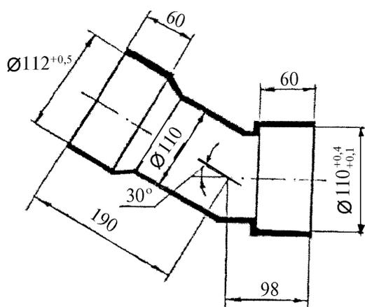
Рисунок 6.13 – Канализационный приборный отвод 30° из НПВХ
