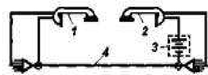
Рисунок 7.45 – Схема прозвонки кабеля с помощью телефонных трубок
