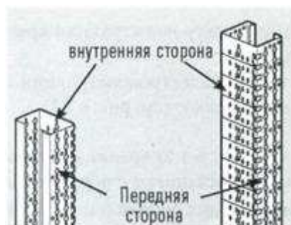
Рисунок 7.3 – Стороны перфорированных монтажных стоек
