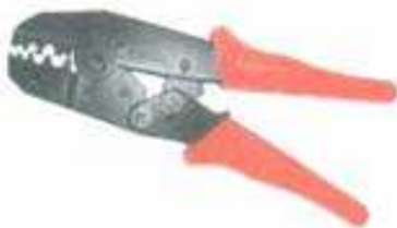
Рисунок 9.6 – Пресс-клещи для опрессовки кабельных наконечников
