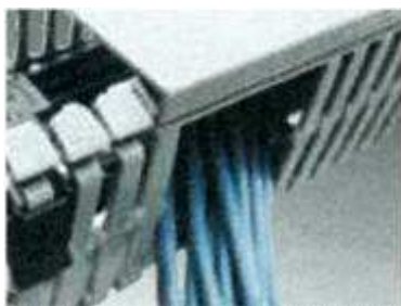
Рисунок 7.37 – Вывод из канала пучка проводов
