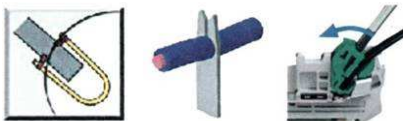
Рисунок 7.17 – Зажим в соответствии с технологией IDC
