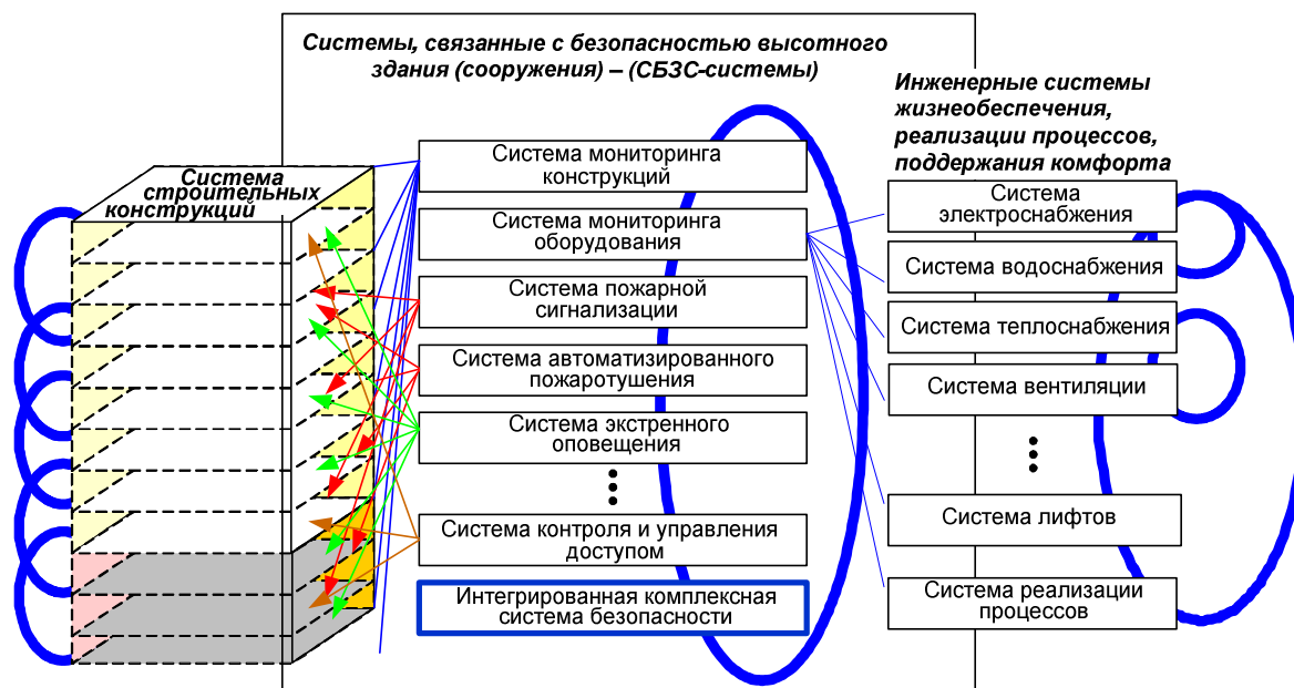
Рисунок 1 – Высотное здание (сооружение) как сложная система (упрощенная модель)
